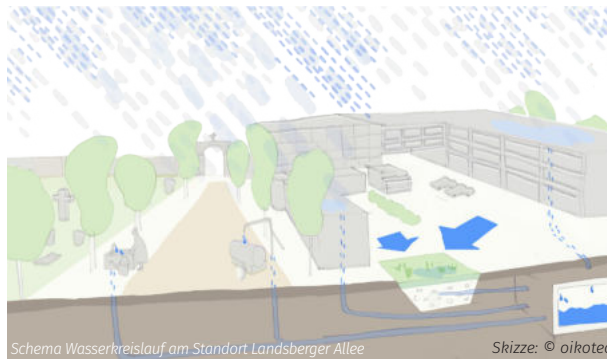
Schema Wasserkreislauf am Standort Landsberger Allee
